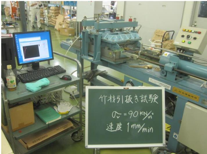
引抜き試験状況
