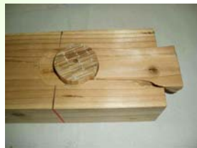
破壊した試験体
