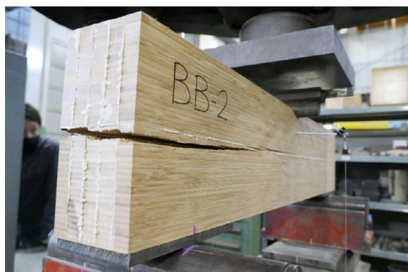
竹集成材(BB試験体)の破断状況
