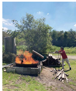
無煙炭化器による 廃牡蠣筏竹材の炭化作業
