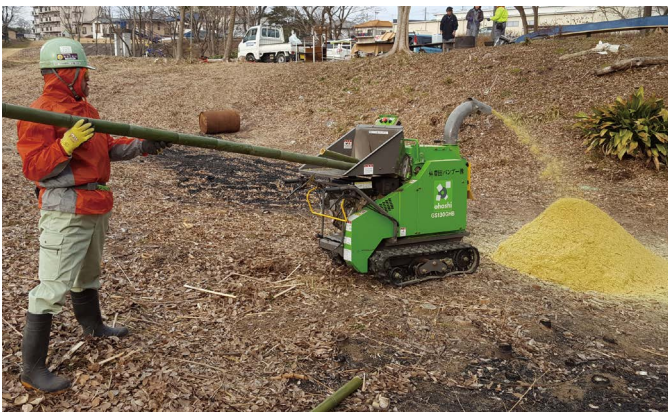
豊田市内河川敷、越戸地区ボランティアさんが切った竹を破砕しています。敷き均し、防草材として使用されるようです。
