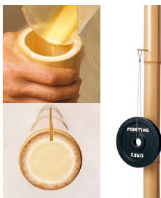
ウレタン樹脂充填 (割れ抑制)
