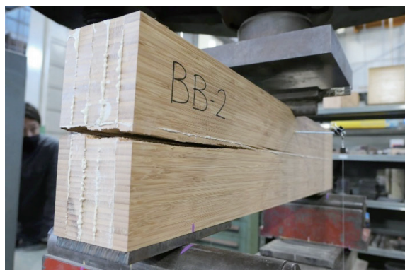
竹集成材(BB試験体)の破断状況
