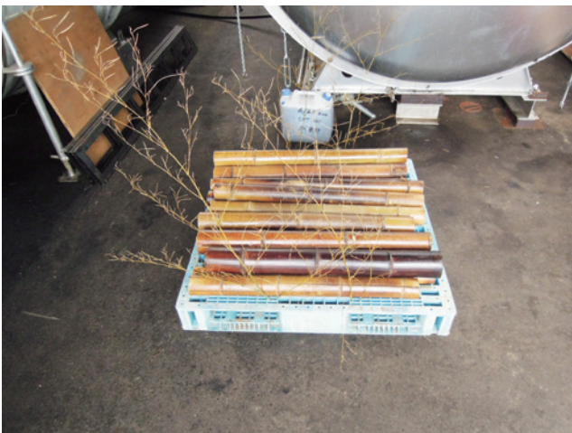
キャビテーション乾燥装置による竹の乾燥状態
