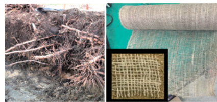
模型斜面の中には、竹林の根茎網を模擬した麻布を配置しています。
