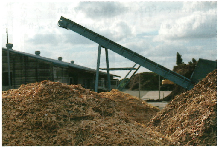
林田産業の中間処理場。竹、剪定木、草などがここに集められ、再処理されていく。竹林は各地で増殖しており、その伐採と利用は大きな課題になっている。用途で関心が高いのはバイオマス燃料、パルプ原料向けだ。その一方で、簡単に竹を伐採する装置の開発も待たれている。
